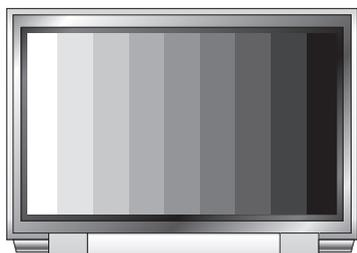
3. カラーバー画像出力中に
